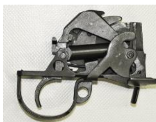
Abbildung 7 Abzugsgruppe eines Springfield Armory Gewehres M1 A oder M 14. Die Rechtsauffassung hat sich geändert! Kein geteiltes Gehäuse und somit auch kein führendes Waffenteil!
