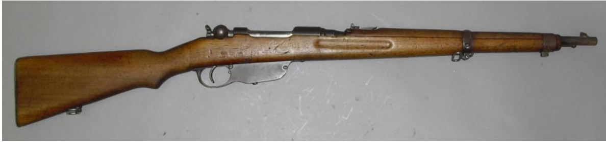
Abbildung 43: Repetierbüchse Steyr-Mannlicher Modell M 95, Geradezug-Repetierer
