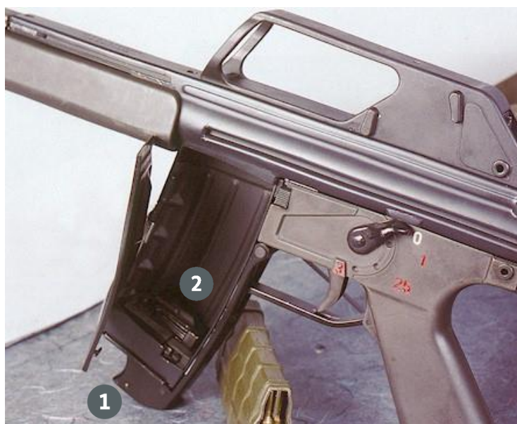
Abbildung 138 Vollautomatische Büchse Heckler & Koch HK 36, Kal. 4,6mmx36, Ansicht linke Waffenseite, Magazinschacht geöffnet, Nachladeeinheit entnommen.
