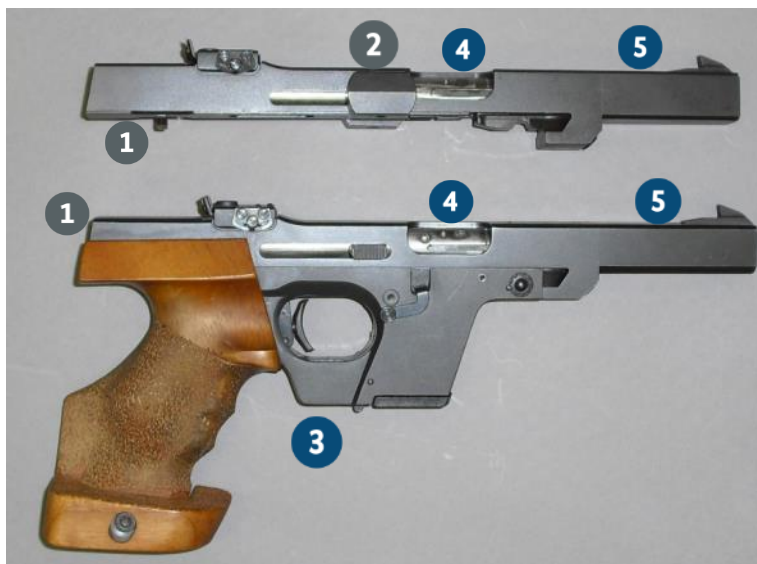
Abbildung 28: Halbautomatische Pistole Walther GSP, Kal. .22lr Ansicht rechte Seite. Im Bild oben ein Wechselsystem für diese Pistole.
