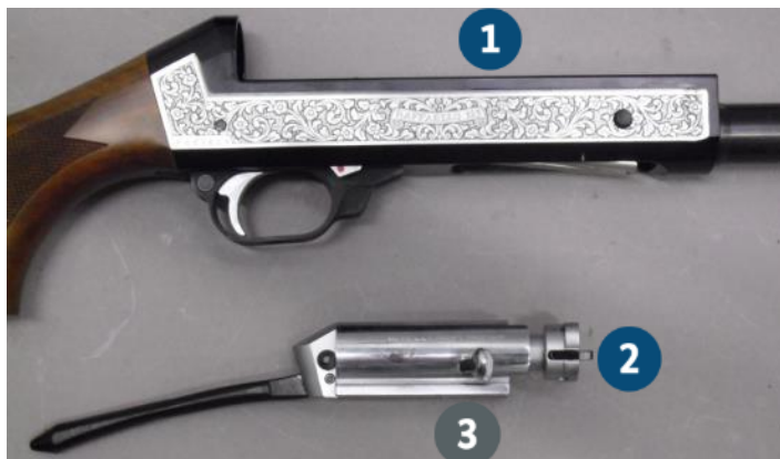
Abbildung 67 Selbstladeflinte Benelli, Gehäuse und Verschluss/-kopf im Detail
