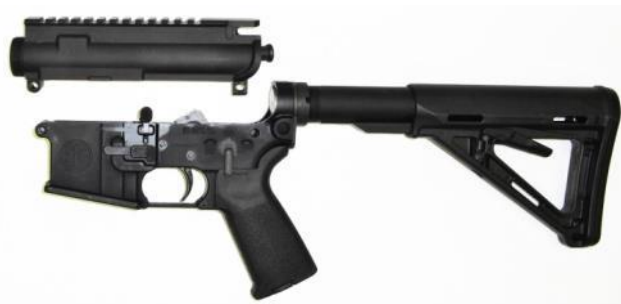
Abbildung 4 Langwaffe auf der Basis Colt AR 15, Aufteilung in oberes Gehäuse und unteres Gehäuse.
