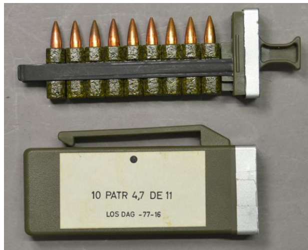
Abbildung 139 Heckler & Koch G11, ursprüngliche hülsenlose Munition mit Nitrozellulose-Pulver
