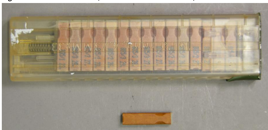
Abbildung 141 Heckler & Koch G11, finale hülsenlose Munition, Nachladeeinheit 15 Patronen
