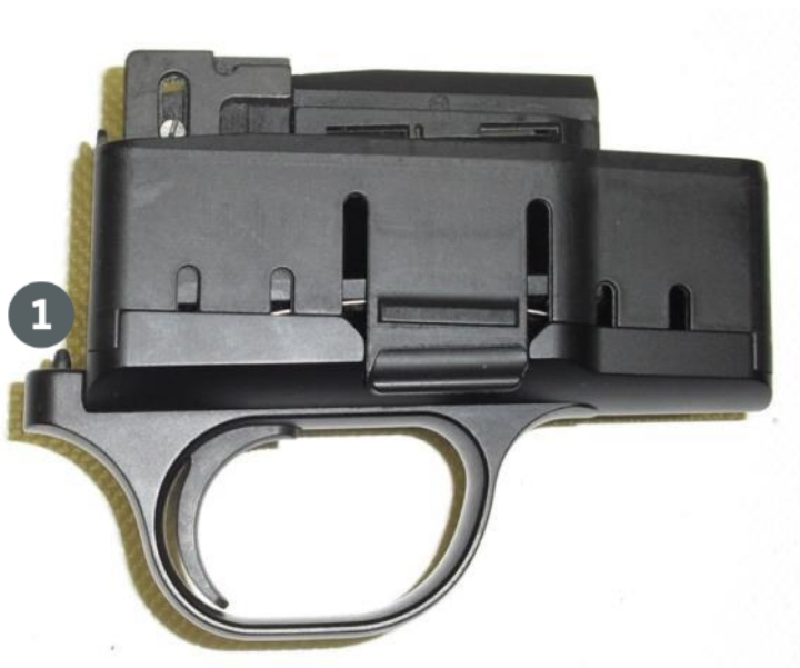
Abbildung 53 Magazin Blaser R 8 mit Fortsatz vom Abzugszüngel/Abzugsblatt 1 Kein wesentliches Waffenteil!
