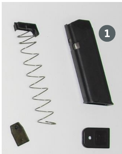
Abbildung 144: zerlegtes Magazin für Glock Pistolen für -17- Patronen. Das Magazingehäuse ist erlaubt.
