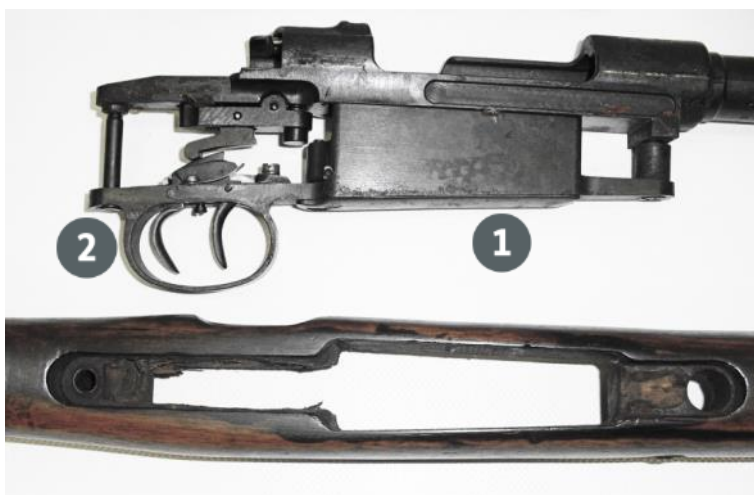
Abbildung 36 Gewehr 98 mit deutschem Stecher. Die Abzugsmechanik ist sowohl auf der Platte am Abzugsbügel als auch an der Systemhülle befestigt.
