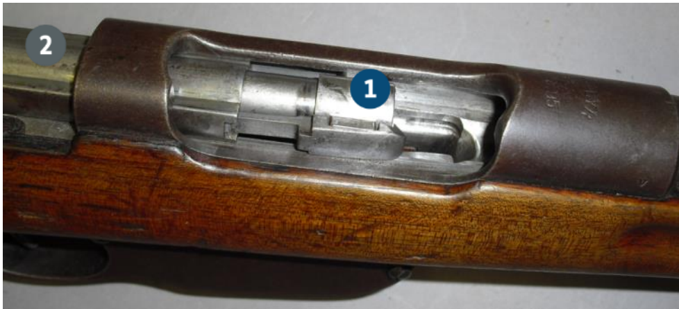
Abbildung 44: Drekkopf des Geradezug-Verschlusses Gewehr Steyr-Mannlicher Modell M 95 komplett.
