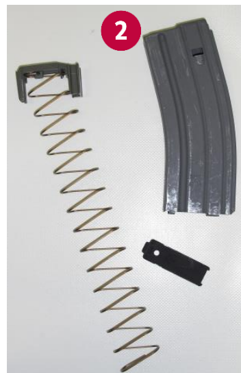
Abbildung 145: zerlegtes Magazin für Büchsen des Typs Colt AR 15/M16. Das Magazin nimmt -30- Patronen auf. Das Magazingehäuse ist verboten!
