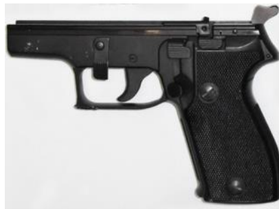
Abbildung 5 Griffstück bezeichnet, am Beispiel einer Pistole SIG Sauer P 225/P6
