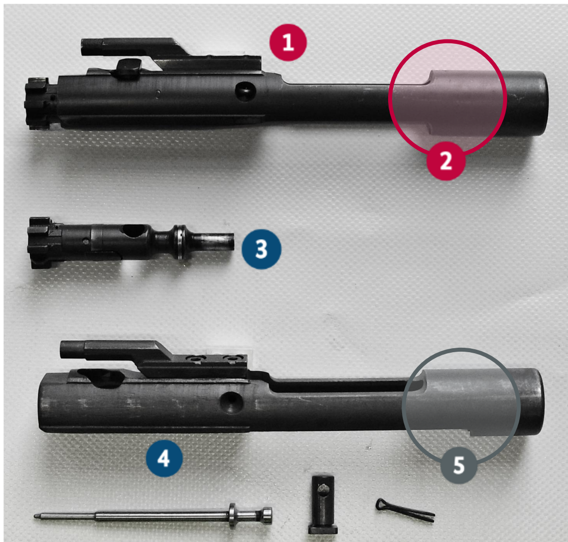
Abbildung 1 Beispiel für unterschiedliche Bauteile „Verschluss“ anhand Colt AR 15/M16
