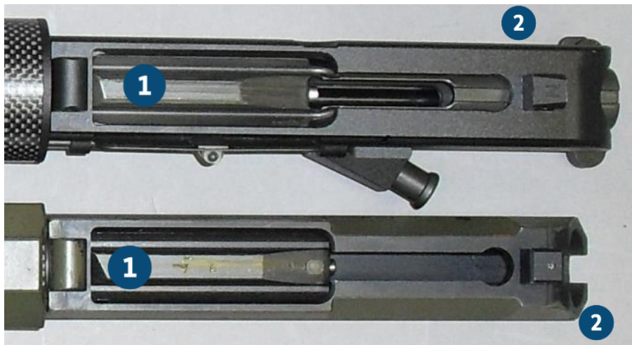
Abbildung 75: Oben oberes Gehäuse und Verschluss halbautomatische Büchse DPMS Modell LR 243, Kal. .243Win. unten oberes Gehäuse und Verschluss/-kopf Troy Defense PAR
