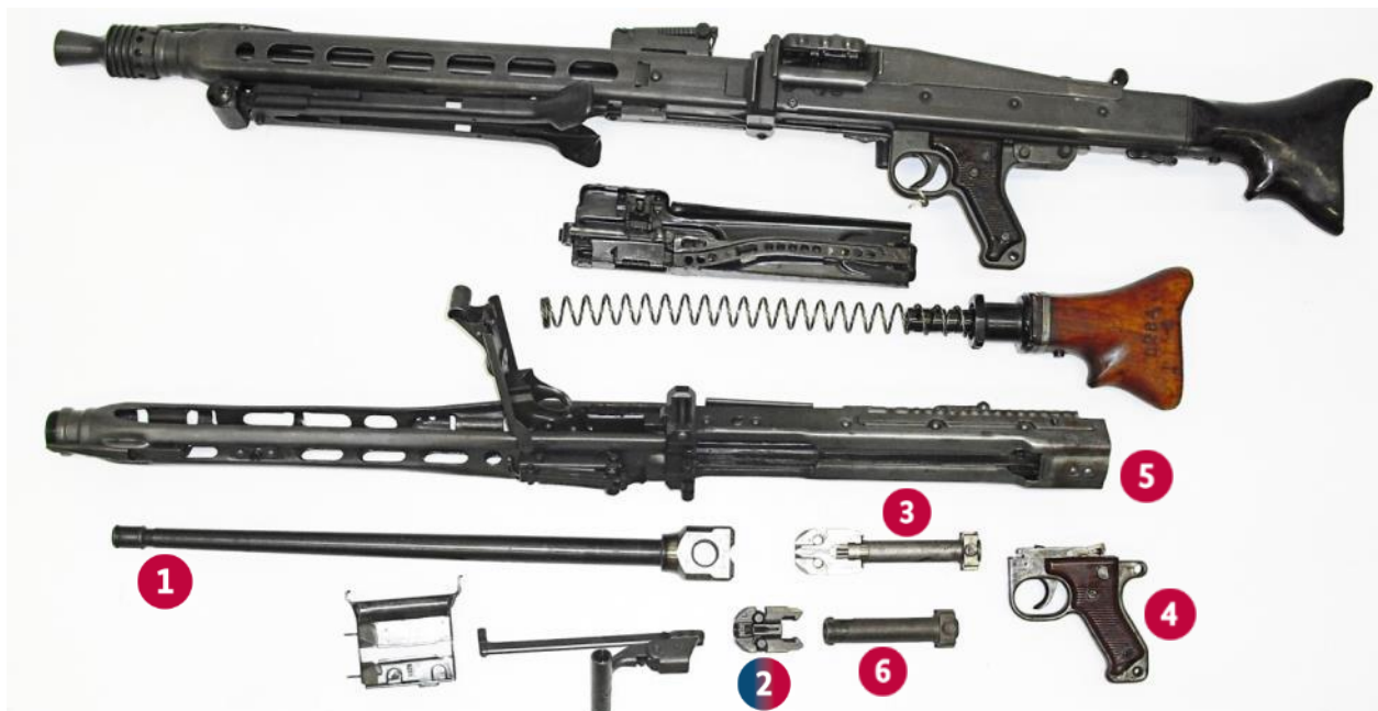
Abbildung 125 Maschinengewehr MG 42/MG 3 zusammengefügt als komplette vollautomatische Kriegswaffe und in zerlegtem Zustand als Einzelteile
