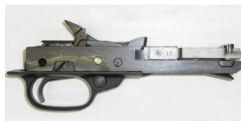
Abbildung 8 Baugruppe Abzug einer Winchester Vorderschaft Repetierflinte. Da es sich um eine Repetierwaffe ohne vollautomatisches Vorbild handelt, stellt die Baugruppe Abzug kein unteres Gehäuse und damit auch kein wesentliches Waffenteil dar.
