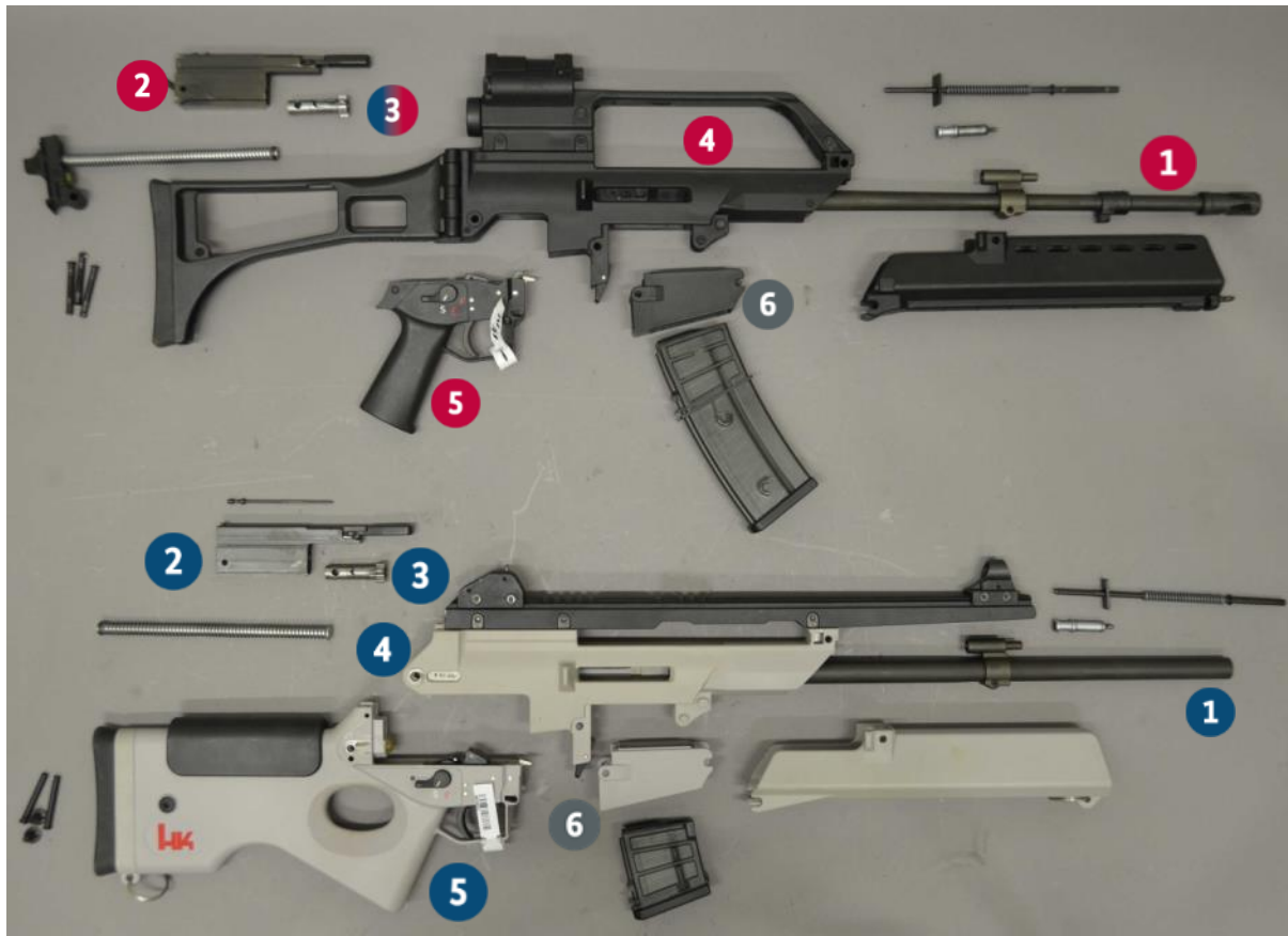
Abbildung 118: Oben vollautomatische Büchse Heckler & Koch Modell G 36, Kaliber 5,56x45., unten halbautomatische Büchse Heckler & Koch, Modell SL 8, Kaliber .223Rem. Der grundsätzliche Aufbau des HK SL 8 findet sich auch beim HK 243/HK 293.
