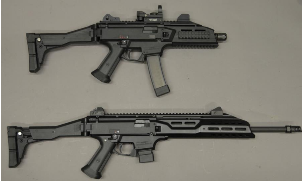
Abbildung 123: Oben vollautomatische Maschinenpistole CZ EVO 3A1, Kal. 9mmLuger, Kriegswaffe, darunter die halbautomatische Büchse CZ EVO 3 S1, Kal. 9mmLuger
