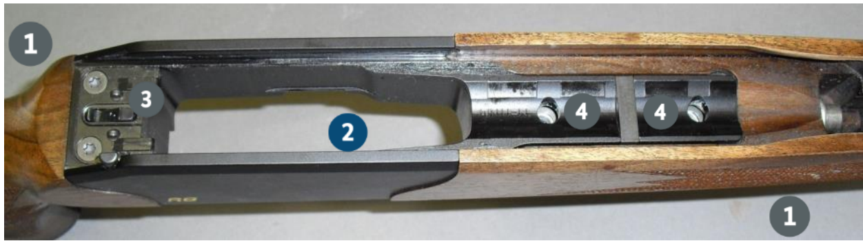
Abbildung 50 Repetierbüchse Blaser R 8 Systemkasten von oben mit zweiteiligem Schaft, jedoch ohne Magazin
