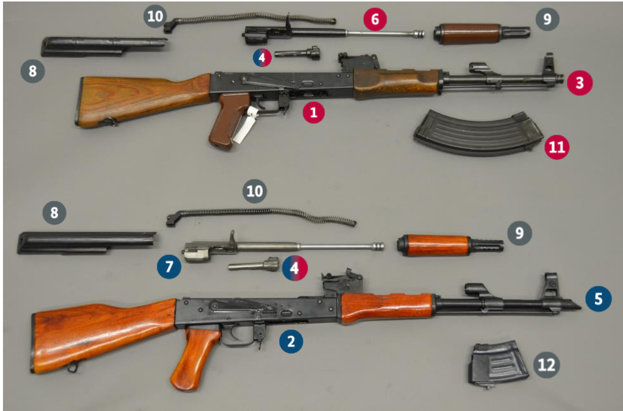
Abbildung 94 Langwaffen Baureihe AK 47 zerlegt in Bauteile oben dauerfeuerfähige Version unten halbautomatische Version
