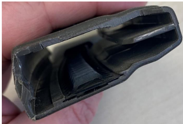
Abbildung 136 Nachladeeinheit für Heckler & Koch HK 36, Ansicht von der Oberseite. Die Funktion der Stege entspricht der Funktion Lade Clips wie in Abb. 133
