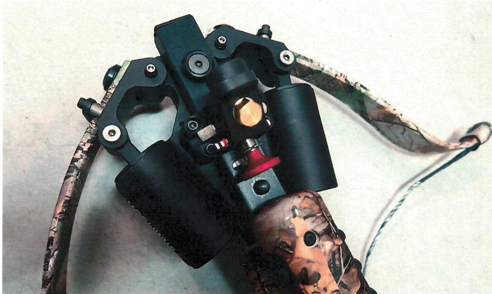
Abbildung 2: Steambow Unterseite, Druckkolbensystem
