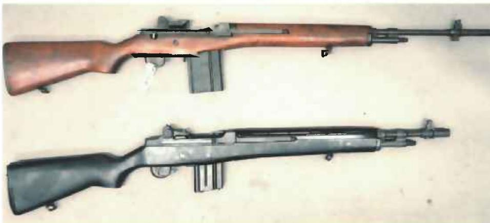
Abbildung 5: Oben vollautomatisches Gewehr Springfield M14 im Kaliber .308 Winchester, unten halbautomatisches Gewehr Kögel BK14 im Kaliber .223Rem, Ansicht links.
