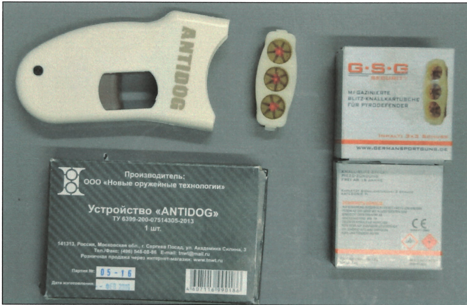
Abbildung 1: Pyro Defender, Version „ANTIDOG“ und dazugehörige Kartuschenmunition
