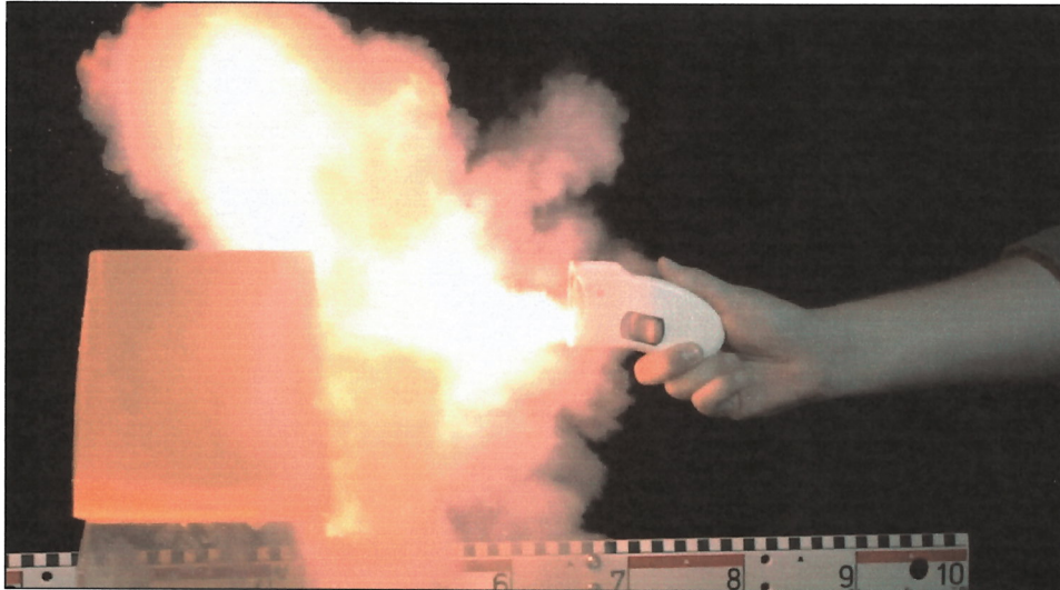
Abbildung 4: Pyro Defender, Schussabgabe auf einen Gelatine Block aus ca. 15cm Entfernung
