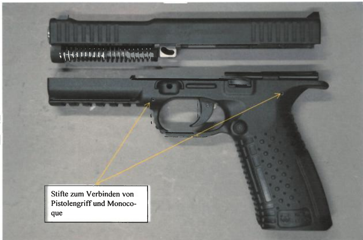
Abbildung 1: Pistole GECO „Stryke“, teilzerlegt, Gesamtansicht links
