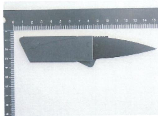
Abbildung 2: Sinclair Cardsharp, fertig zum funktionsfähigen Messer gefaltet
