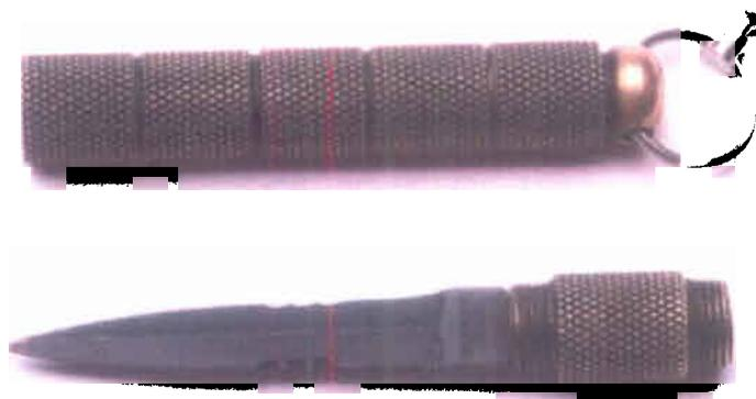
Es handelt sich um eine aus Messing hergestellte und mit einer Kreuzrändelung versehene zylindrische Hülse. Sie ist ca. 107 mm lang und hat einen Außendurchmesser von etwa 14 mm. An einem Ende ist ein Schlüsselring befestigt, am anderen Ende ist ein Außengewinde
